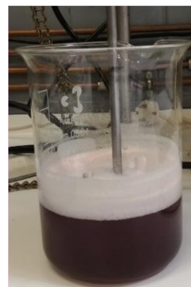
Figura 2.A (izquierda): Aspecto de la emulsión después de 10 minutos de agitación mecánica con palas. Figura 2.B (derecha): Aspecto de la emulsión después de 60 minutos de agitación mecánica con palas.
