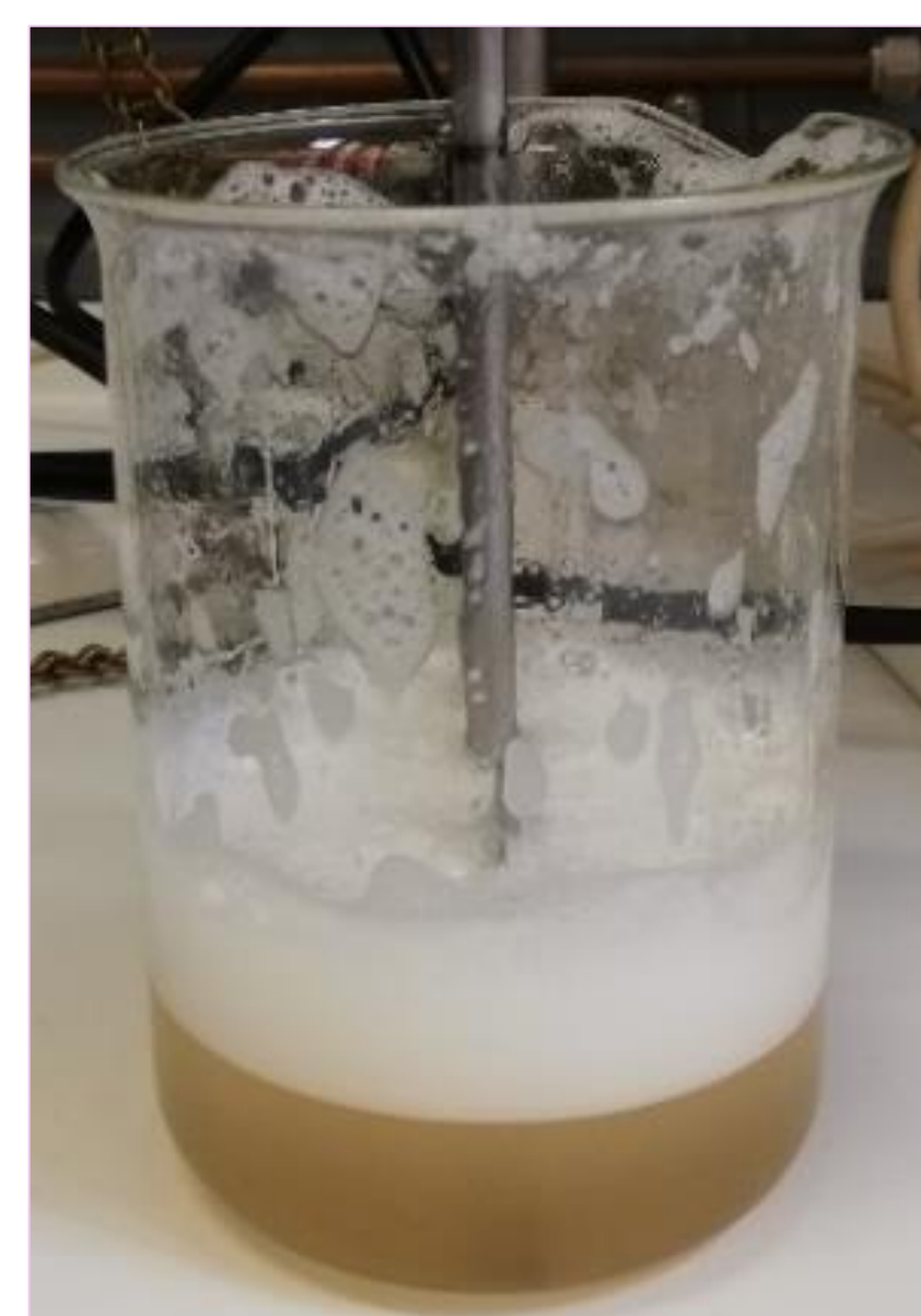
Figura 2.A (izquierda): Aspecto de la emulsión después de 10 minutos de agitación mecánica con palas. Figura 2.B (derecha): Aspecto de la emulsión después de 60 minutos de agitación mecánica con palas.
