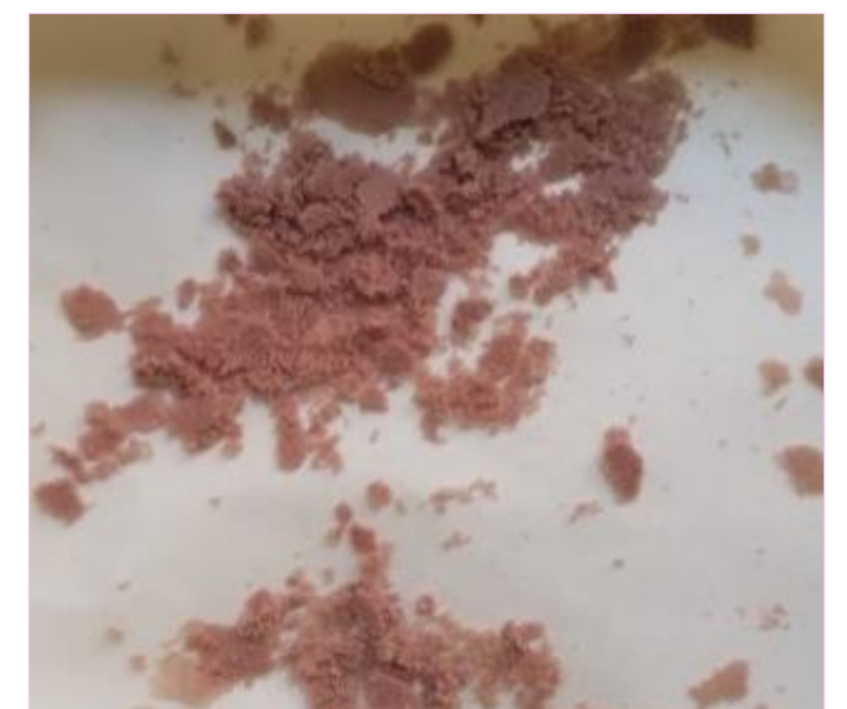
Figura 3: Aspecto de las microesferas después del proceso de secado (24 h, temperatura ambiente).
