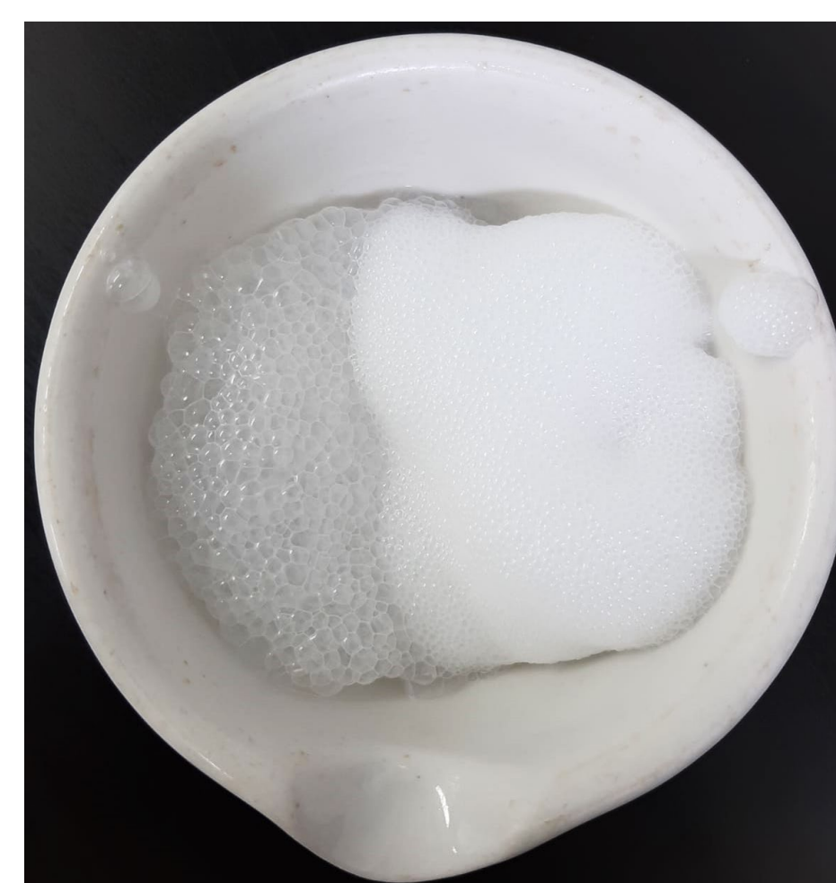
Figura 1. Resultados de la prueba 1. A la izda. la muestra R02 y a la dcha. la R01, con un tamaño de burbuja menor.
